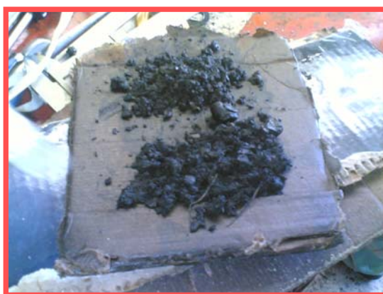
شکل (۱۴) شینه خروجی سوخته ترانسفورماتور فولاد مبارکه اصفهان در دمای بالاتر از ۷۰۰ درجه سانتیگراد (راست) و بقایای کربنیزه شده جسم خارجی پیدا شده
